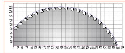
**Schnittbereiche Kappanlagen SERIE TOM: vertikale + horizontale Sägeblattverschiebung**
